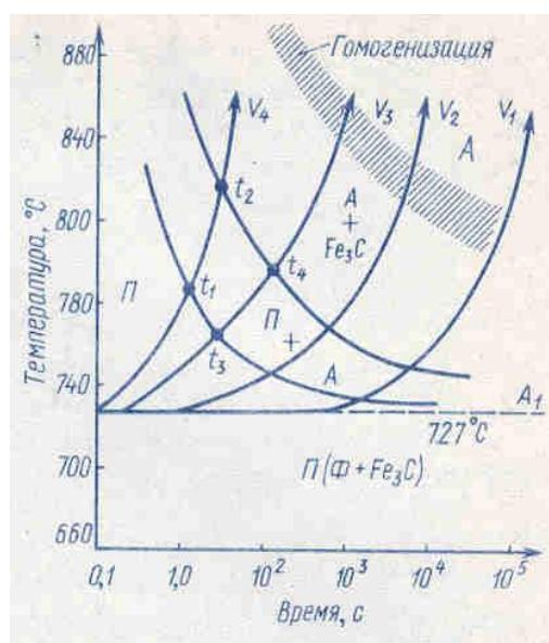
Рис.7.2 – Диаграмма образования аустенита при непрерывном нагреве.
