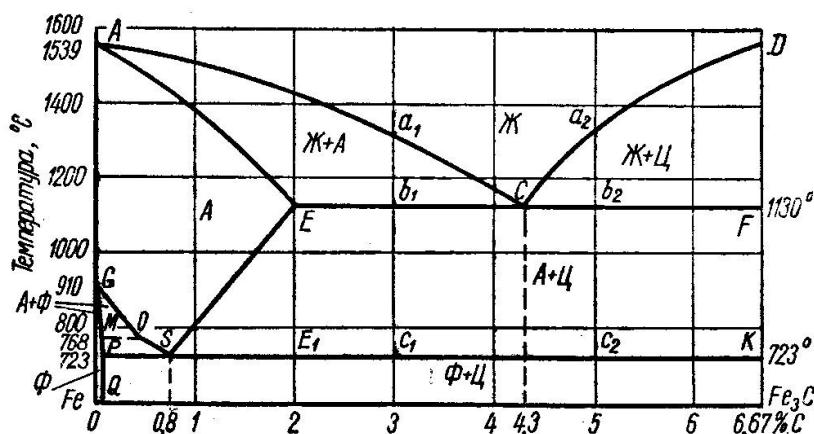
Рис.7.1. Диаграмма состояния системы Fe – Fe<sub>3</sub>C
