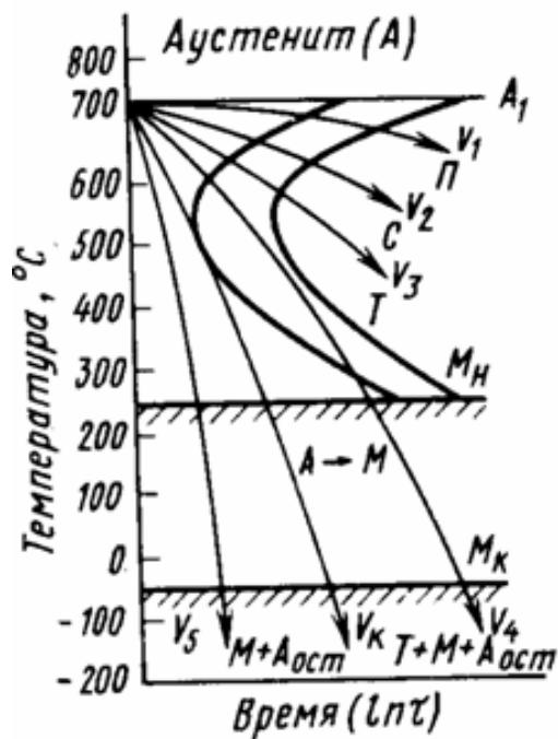
Рис.7.5 – Диаграмма распада аустенита при непрерывном охлаждении
