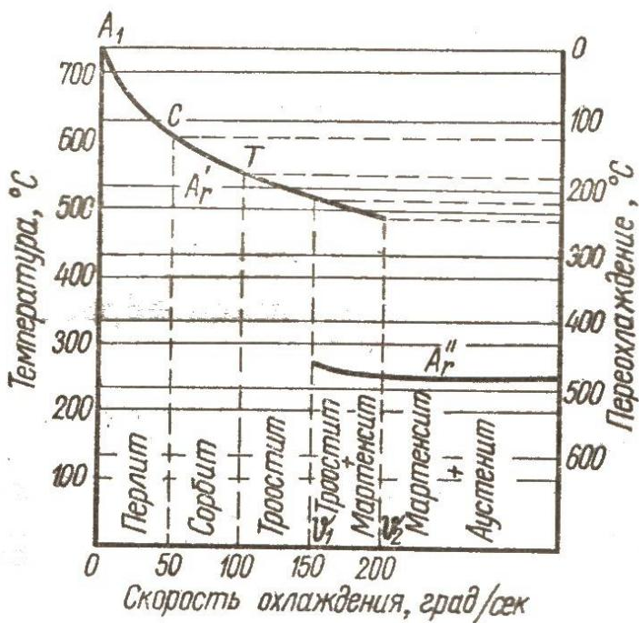
Рис.7.3 - Зависимость положения критических точек эвтектоидной стали от скорости охлаждения.
